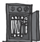
屋内消火栓設備
