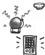
自動火災報知設備
